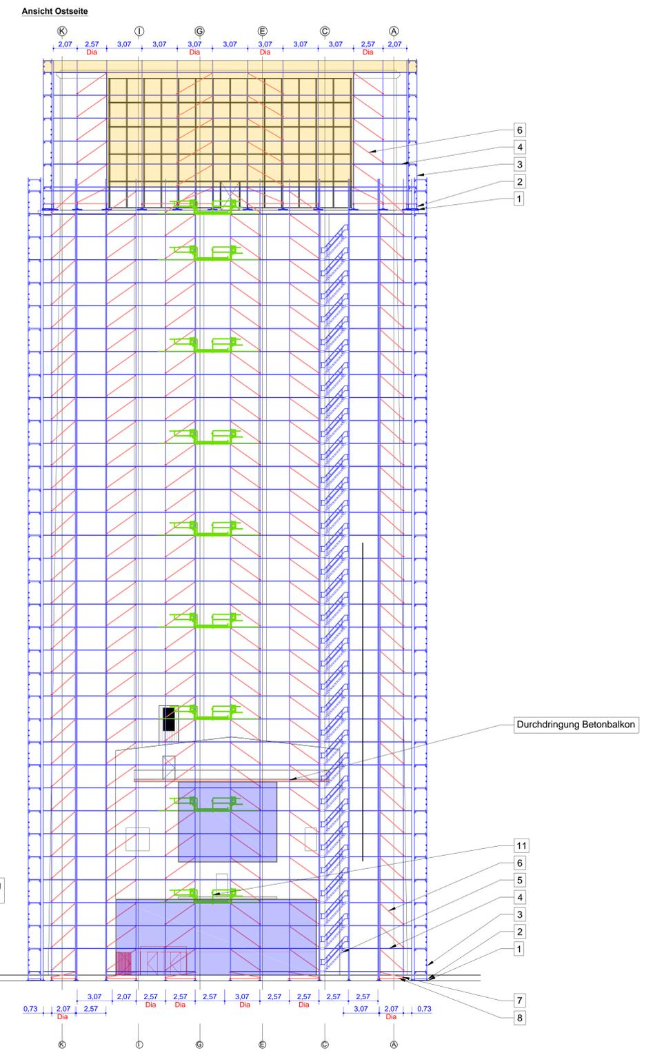
**Gründung:** Die Gründung am Boden bei -0,50m erfolgt mit lastverteilenden Unterlagen und Normalspindeln. Die Ausspindelung der Normalspindel beträgt max. 0,15m. Die Gründung auf dem Podest bei +66,60m erfolgt mit einer dreilagigen Lastverteilung siehe Plan 101061-18-05-01.
